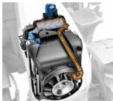
Sopra, la versione definitiva e in serie del trattore new Holland "T6" alimentato con gas metano. Sotto, il sistema Fendt preposto a ripulire i filtri aria
