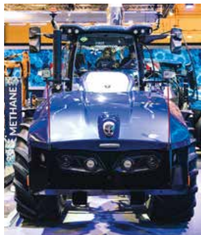
Sopra, la versione definitiva e in serie del trattore new Holland "T6" alimentato con gas metano. Sotto, il sistema Fendt preposto a ripulire i filtri aria
