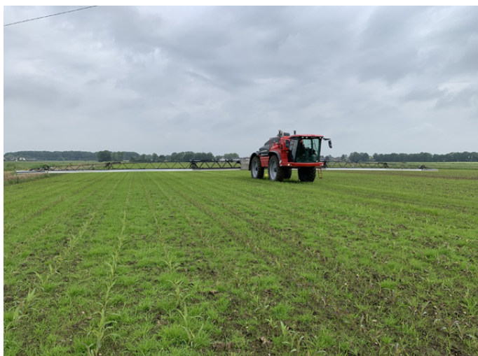
Di recente acquisto, i Ten Hove possiedono anche un'irroratrice semovente Horsch PT6300 con serbatoio da 6.000 litri e barra da 36 metri
