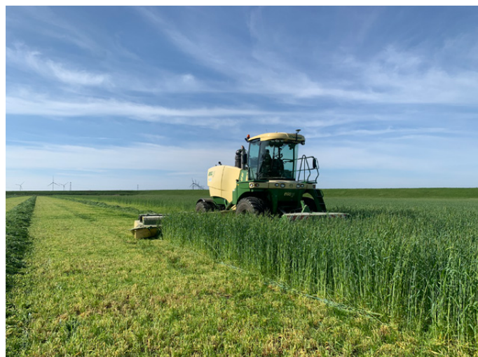
Krone Big M in operazioni di sfalcio. Può disporre il prodotto falciato in una singola andana oppure lasciarlo a terra sull'intera larghezza di lavoro
