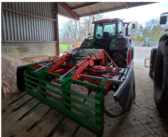
Attrezzo spargiforaggio Holaras, molto diffuso nel nord Europa per l'insilamento dei foraggi. Lavora in modo simile a uno spandivoltafieno, evitando la formazione di sacche d'aria in trincea e distribuendo il foraggio trinciato in modo ottimale
