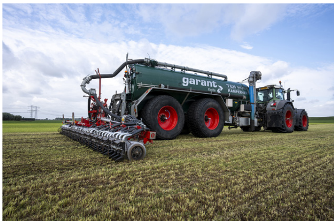
Botte per liquami Garant abbinata agli iniettori a calata Evers Quadro Disc, per un'efficiente distribuzione superficiale del liquame su prato. Da notare la gommatura Generosa e il Sistema di controllo pressione pneumatici installato sia sulla botte sia sul trattore
