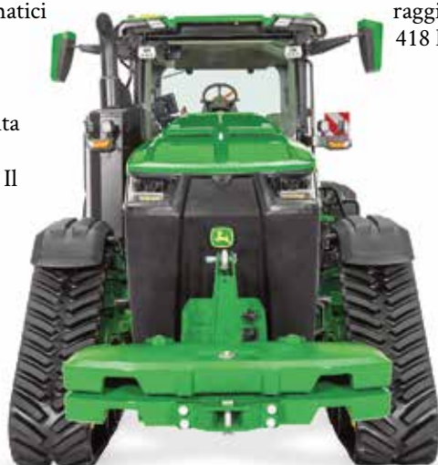
Le versioni cingolate "8Rx" propongono larghezze massime superiori di 111 millimetri rispetto ai modelli gommati "8R"
