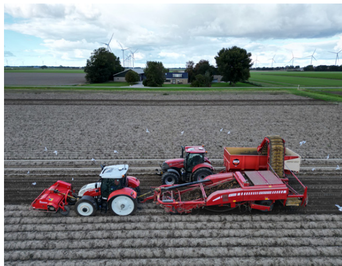
Cantiere per la raccolta di patate. La raccogliatrice Grimme, acquistata in condivisione, è trainata dallo Steyr 4130 Cvt
