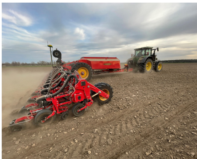
Väderstad Tempo L18 al lavoro. La macchina può essere riconfigurata a dodici elementi per la semina di colture con interfila a 75 centimetri, come il mais
