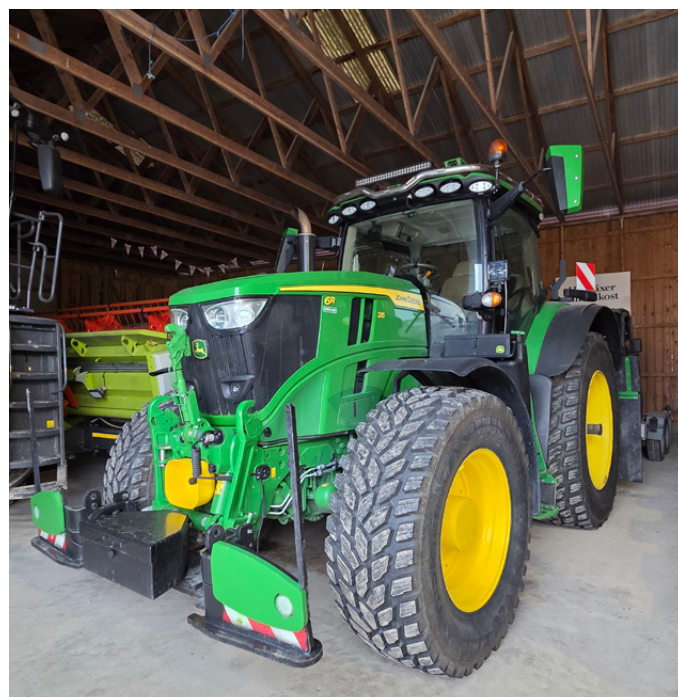
John Deere 6R.215 allestito con pneumatici stradali invernali Nokian Tyres. Durante la stagione autunnale-invernale, il trattore è usato principalmente per il trasporto su strada dei mezzi forestali, tramite pianali appositamente sagomati
