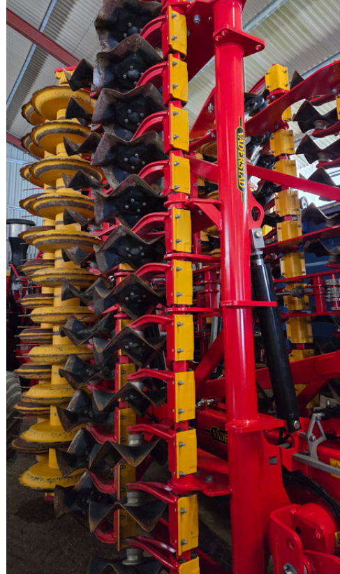
Väderstad Carrier XT 625, configurato con dischi CrossCutter. Questo allestimento consente una lavorazione ultra-superficiale, per un rimescolamento intensivo dei primi 2-3 centimetri di terreno
