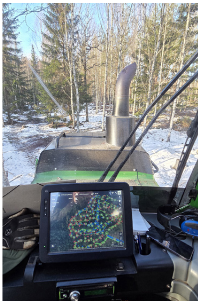
Vista dalla cabina del forwarder 1510G. Si notano le coordinate Gps del tracciato seguito dall'abbattitrice. L'operatore seguirà tali coordinate per dirigersi verso i tronchi abbattuti in precedenza
