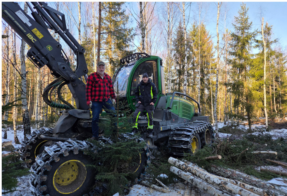
Fredrick e Kenneth in posa sull'abbattitrice John Deere 1170G. Il mezzo abbatte e srama i tronchi, contrassegnando il luogo di deposizione del legname con coordinate GPS poi condivise tramite cloud per il successivo passaggio del forwarder
